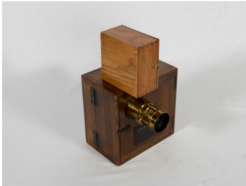
Caméra-tireuse-projecteur 35 mm Lumière-Carpentier Cinématographe, Collection Cinémathèque québécoise 1995.0218.01-17. AP TECHNÈS CC BY-SA 4.0
